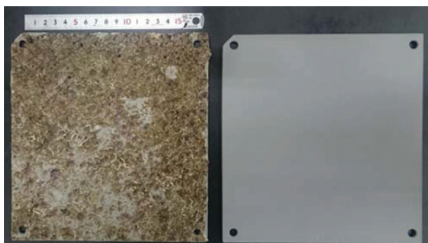
生物を付着させた試験片(右は海水に浸す前)
