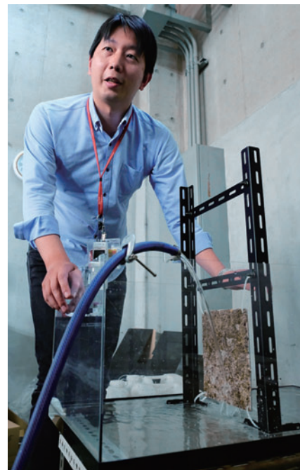
生物付着の超音波計測用の装置
