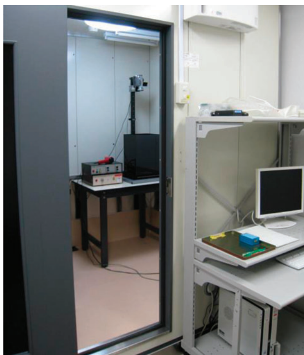
防音箱の中に行動解析装置をセットし、パソコンと連動
