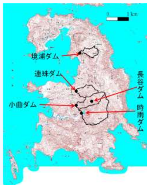
図2 父島におけるダムの分布と集水域 (数値地図 25000 (地図画像) により作成)
